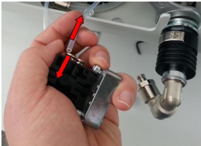
Schlauch durch das Loch im Grundkörper ziehen
