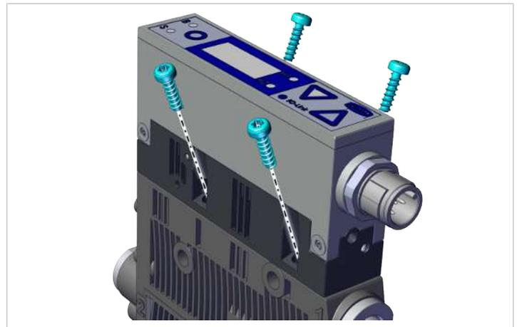
2. Vakuummodul (1) von der Steuerung (2) trennen **1** und die Druckfedern und Dichtungen entnehmen **2**.
