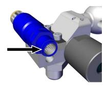
Anschlusskabel am Elektrischen Anschluss einstecken und befestigen (max. Anzugsmoment = handfest).
