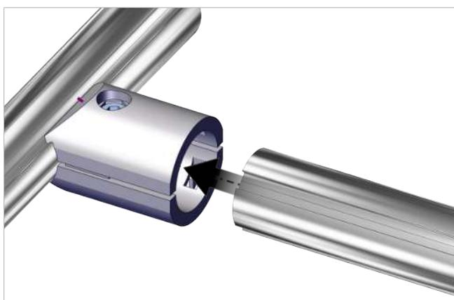
4. Den Verbinder auf die definierte Position bewegen und alle Bauteile mit der Schraube fixieren/klemmen.
