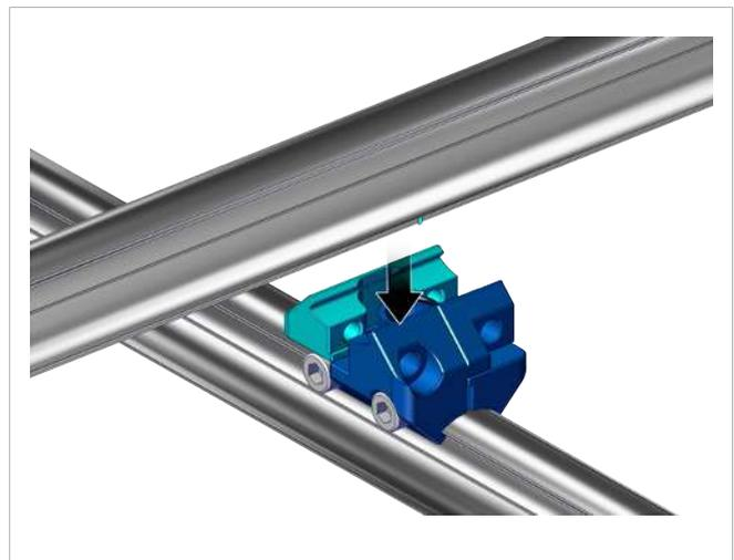
6. Die montierte Baugruppe befestigen. Die Schrauben mit einem Anzugsmoment von  $9 \text{ Nm} \pm 2 \text{ Nm}$  anziehen.
