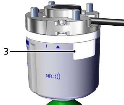
Das Typenschild (3) ist fest mit der Mini-CobotPump (im nachfolgenden als ECBPMi bezeichnet) verbunden und muss immer gut lesbar sein. Es enthält die selben Daten wie das Typenschild (2).
