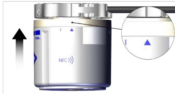
3. Die ECBPMi um 15° (bis Anschlag) im Uhrzeigersinn drehen (Strichmarkierung stimmt mit der Kerbe am Adapterflansch überein).
