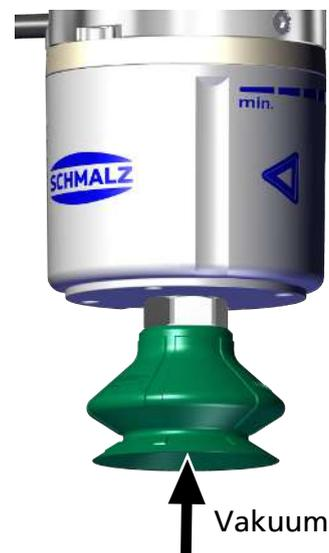
Ein typischer Handhabungszyklus ist unterteilt in die drei Phasen: Ansaugen, Ablegen und Ruhezustand. Zur Kontrolle, ob genügend Vakuum aufgebaut wurde, wird während des Saugens der Grenzwert H2 durch einen integrierten Vakuum-Sensor überwacht und über OUT2 an die übergeordnete Steuerung ausgegeben.
