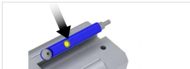
2. Spingere il sensore fino al fine corsa della scanalatura a T
