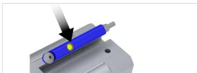
2. Poussez le capteur dans la rainure en T jusqu'à la butée
