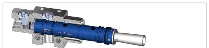
2. Le vissage (à la main) du capuchon SHC (3) ou du silencieux SHC-SD permet de fixer le module d'éjecteur (2) dans l'alésage du carter (1).
