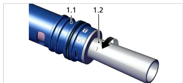
2. Düsenstock (1.2) aus dem Grundkörper (1.1) ziehen, dabei nur axiale Kräfte aufbringen
